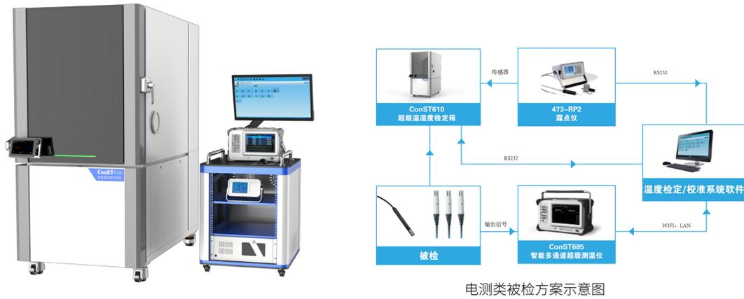
该系统主要用于温湿度传感器、温湿度变送器具备电信号输出功能，及无数数据接口的机械式温湿度计、数字式温湿度计等温湿度仪表的检定、校准和测试工作。
