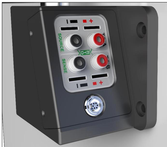
标准铂电阻控温设置方法：主菜单-系统设置-控制设置-控温标准-外部-传感器类型-选择标准铂电阻编号-点击
