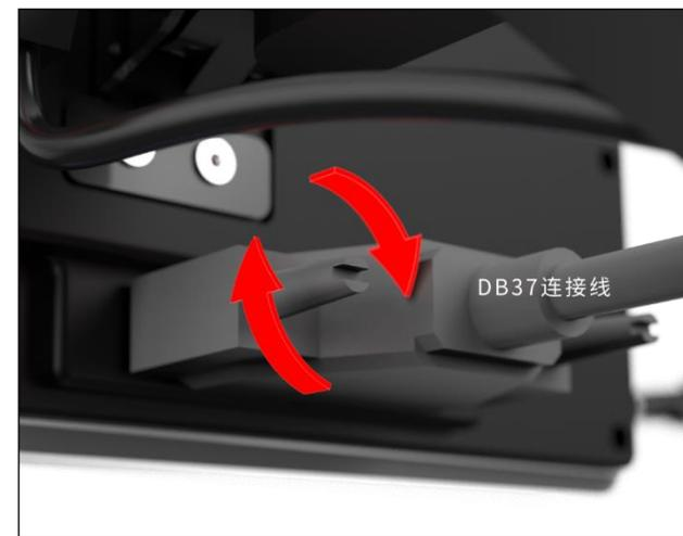
图 2-8 安装连接线
