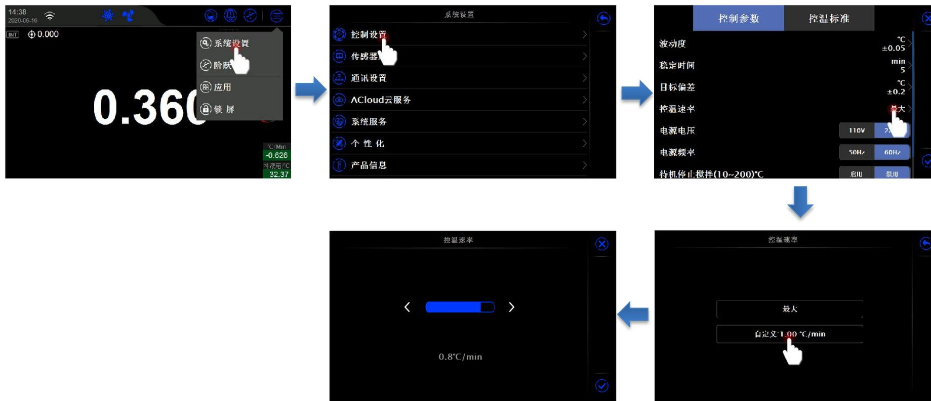
选择较高目标温度值，升降温开关启动
