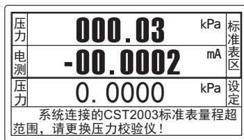
图7-2-6 标准表量程不符合发生器的要求
